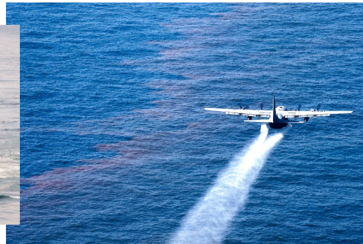
Распыление диспергента по поверхности разлитой нефти
