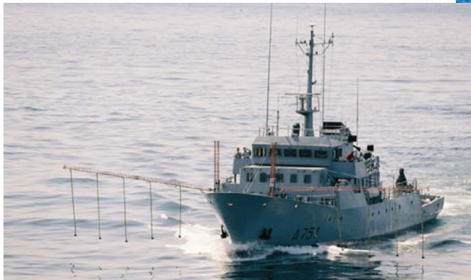
Распыление диспергента по поверхности разлитой нефти
