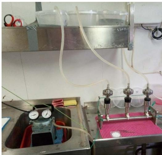
Рис. 10. Вакуумный насос и установка для фильтрования морской воды на определение концентрации хлорофилла в условиях судовой лаборатории (фотография Калинка О.П.)
