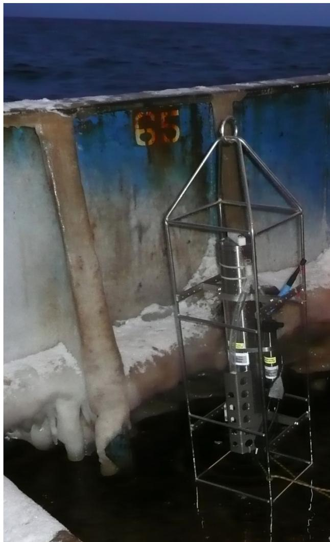
Рис. 3. СТД-зонд SEACAT SBE 19 plus V2 (фото Е. Расхожевой)
