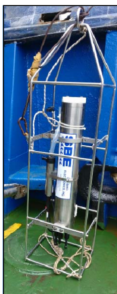
Рис. 3. СТД-зонд SEACAT SBE 19plus V2 (фотография Дерябина А.А.)
