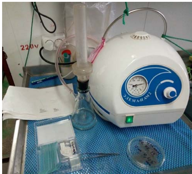
Рис. 9. Вакуумный насос и установка для фильтрования морской воды на определение количественных показателей гетеротрофных жгутиконосцев в условиях судовой лаборатории (фотография Калинка О.П.)
